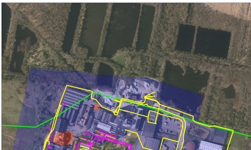
Figur 11. Elkabler tilhørende SEAS NVE A/S, nu Cerius, på og omkring Holmegaard Glasværk vist med gul streg for 10 kV elkabler og pink streg for 0,4 kV elkabler i skala 1:7.000 på GeoDanmarks ortofoto fra 2017, ©SDFE. Med blå farvetone er vist de muligvis jordforurenede arealer områdeklassificeret på vidensniveau 1 og med rødbrun farvetone områder klassificeret som forurenede på vidensniveau 2. Undersøgelsesområdet/projektområdet er her afgrænset med en grøn streg.
