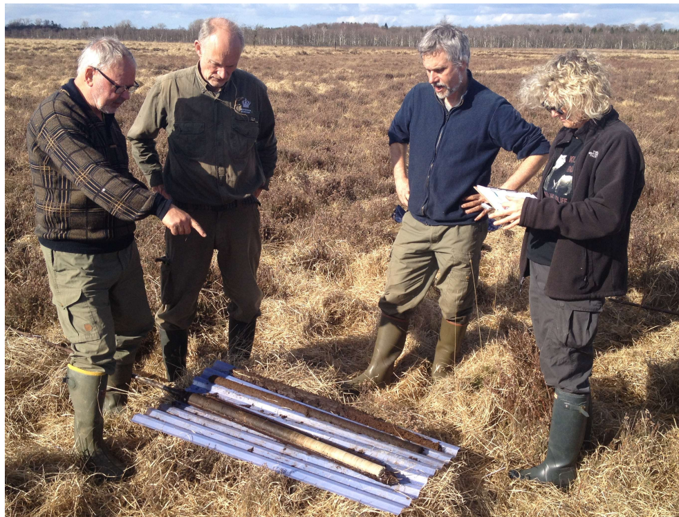
Figur 4. Fra borearbejdet i Holmegårds Mose. På pladen i forgrunden ligger russerboret med borekerne på sværdet med en tydelig overgang til den lyse kalkgytje.
