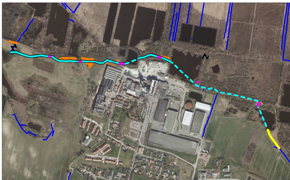
Figur 38. Det nye vandløbsforløb fra Glasværksengen til udløb i Svenskegrøften er vist med lyseblå streg for de åbne strækninger og med lyslilla streg for de rørlagte strækninger. Den eksisterende rørledning er vist med gul streg og med de nuværende vandløb i mørkeblå streg på baggrund af GeoDanmarks ortofoto fra foråret 2019, ©SDFE og Danske Kommuner i skala 1:12.000.
