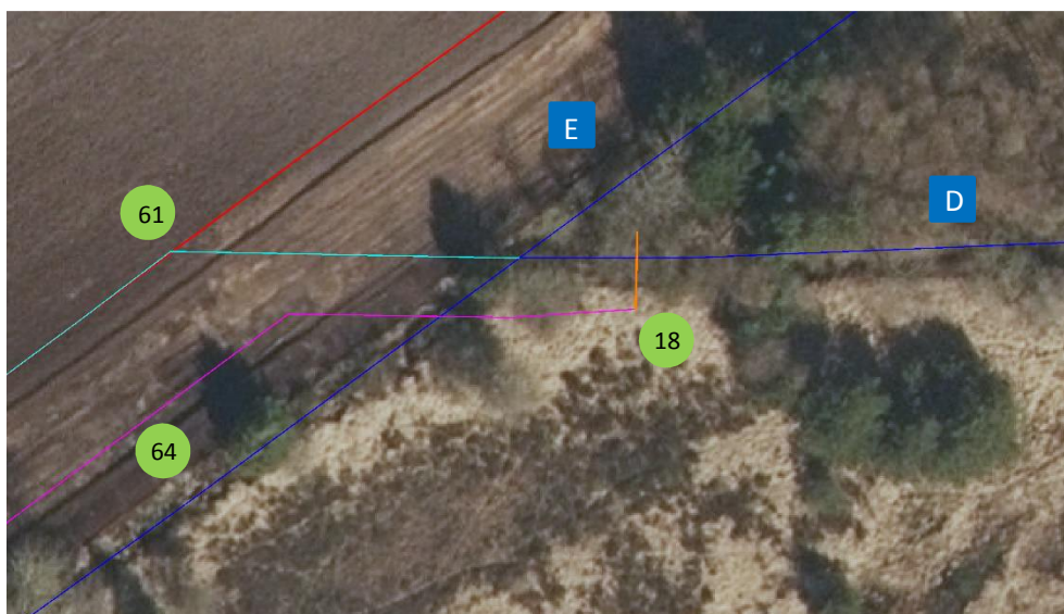
Figur 12: Oversigtlig angivelse af sammenløb af vandløb E og D, samt forlægning af vandløb E. Projektgrænse (rød streg), membran (pink streg), ny grøft (lys blå streg), eksisterende grøfter (mørk blå streg) nyt regulerbart stem nr. 18 (orange streg), element nr. er angivet med grøn boks. Figuren er ikke målfast.
