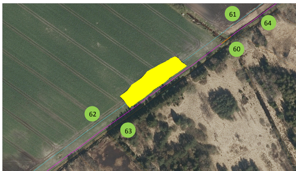
Figur 10: Placering af terrænregulering i forbindelse med etablering af ny grøft (element nr. 62). Membran (element nr. 63 og 64) er angivet med pink streg, hovedstem (element nr. 60) med orange streg, nye afskærende grøfter (element nr. 61 og 62) lyseblå streg og terrænregulering gul markering.
