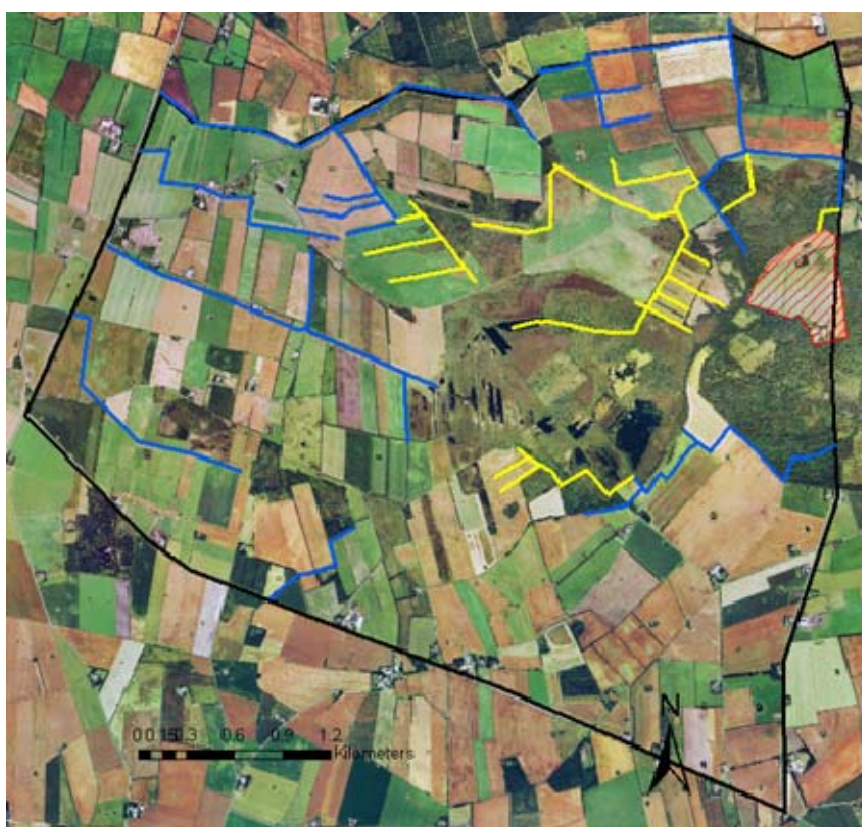
Figur 5 Vandløbssystem der er fjernet i scenariet er markeret med gult. Blå linier viser det resterende vandløbssystem, og modelområdet er markeret med sort linie. Arealet ved Frederiksgård hvor dræningen er afbrudt er markeret med rødt.
