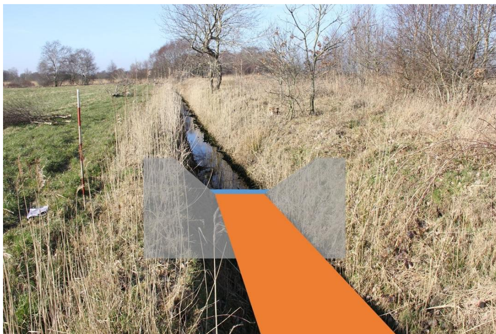
Figur 3: Principskitse for etablering af opstemning ved sætning af jernplade (gråflade) og efterfølgende opbygning af stryg (orange flade) ved element 34 på bilag 1.3. Bemærk, at stensikring af skråningsanlæg mm. ikke fremgår af figuren.
