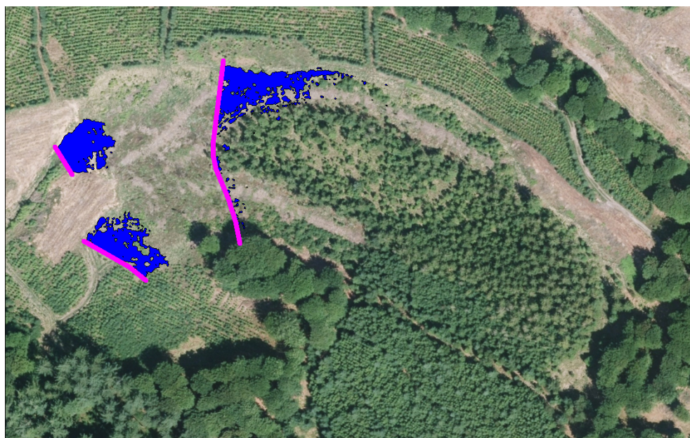
Figur 9. De foreslåede membraner i Brændemose vist med en lilla streg sammen med de forventede åbne vandflader i kote 46,6 m DVR90 mod vest og 47,4 m DVR90 mod øst vist med blå farve i skala 1:3.000 på baggrund af DDO®2016, ©COWI.
