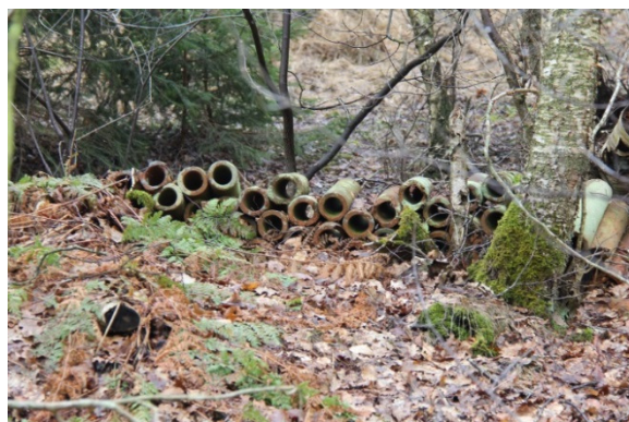
Figur 5. Opgravede drænrør fra Tuemosen (ved lokalitet 4).
