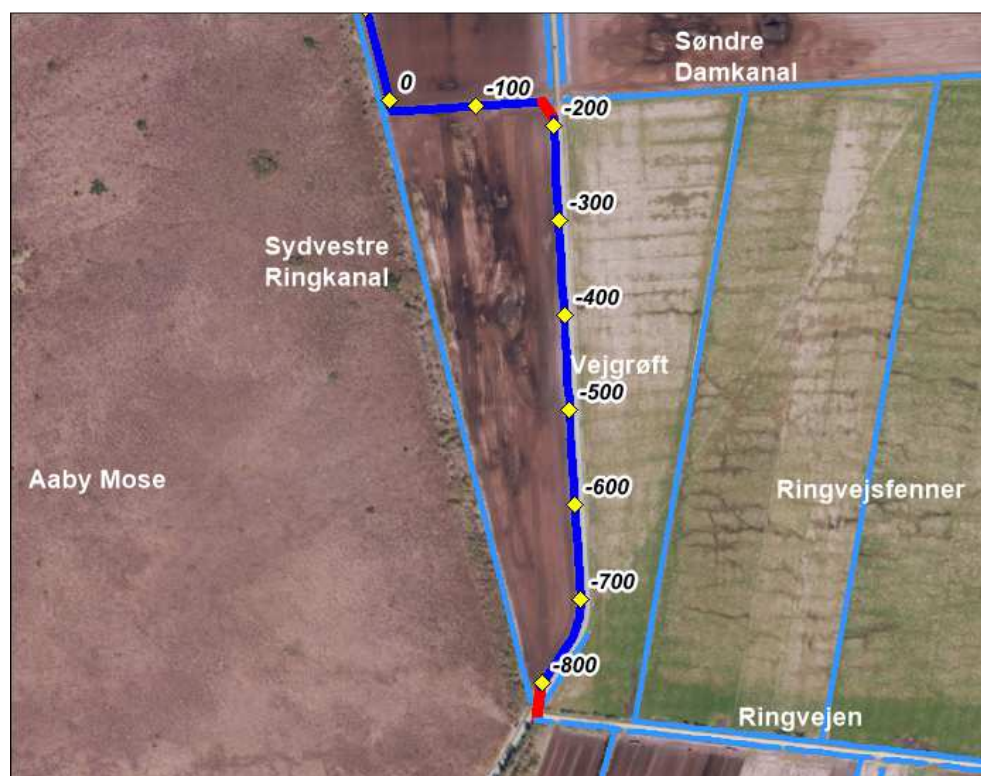
Figur 3. Forløbet af den nye Sydvestre Ringkanal langs vestsiden af Damvej vist med kraftig blå streg og rørlægninger i fed rød streg samt med gule stationeringsmærker per 100 m. Eksisterende grøfter er vist i lyseblå streg på baggrund af GeoDanmarks ortofoto fra 2017, ©SDFE i skala 1:8.000.
