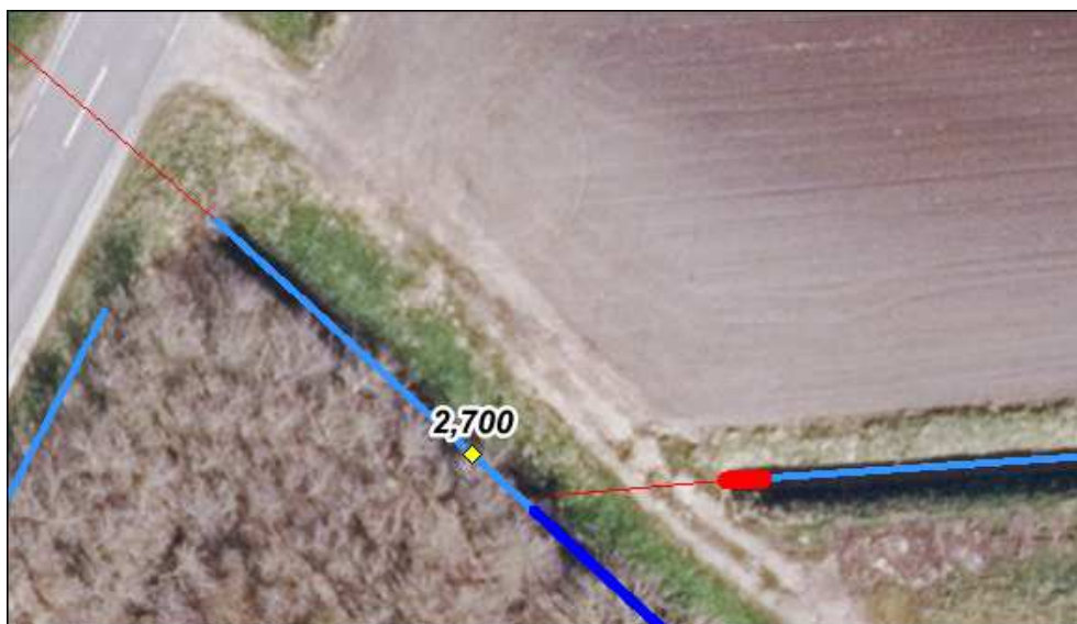
Figur 13. Detailudsnit af projektkortet med den forlængede røroverkørsel i Nordre Damkanal vist med kraftig rød streg, vandløb i blå streg og andre rør i tynd rød streg på baggrund af GeoDanmarks ortofoto 2017, ©SDFE i skala 1:500.
