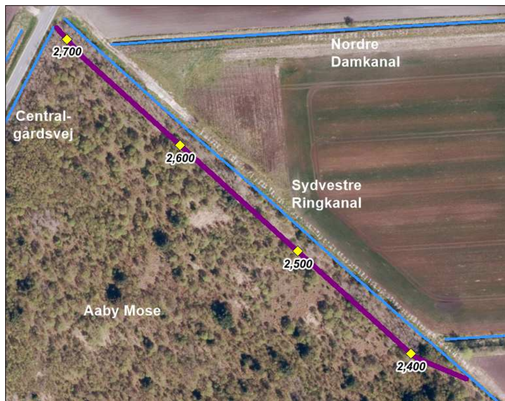
Figur 6. Forløbet af den nordlige membran i Aaby Mose vist med kraftig lilla streg med gule stationeringsmærker per 100 m og eksisterende grøfter med lyseblå streg på baggrund af GeoDanmarks ortofoto fra 2017, ©SDFE i skala 1:2.500.
